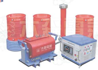
MSXZ(f)-108kVA/108kV 串联谐振耐压试验装置:该装置主要针对 10kV、35kV 电缆,10kV、35kV 主变,35kV 开关的交流耐压试验设计制造。具有较宽的适用范围,是地、市、县级高压试验部门及电力安装、修试工程单位理想的耐压设备。该装置主要由变频电源、励磁变压器、电抗器、电容分压器、补偿电容器组成。
